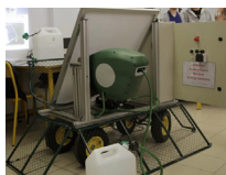
Station de pompage et d'éclairage autonome. Elèves de Terminale STI2D Lycée Janot de Sens.
