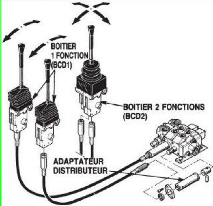
Pour des raisons de sécurité, nous avons proposé au C.F.P.P.A. un système de commande manuelle à distance pour éviter que la pression hydraulique soit proche du formateur et de la personne formée.
