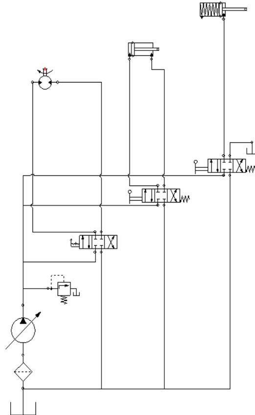
Le montage existant est un montage à commande manuelle avec le distributeur en cabine. Celui-ci étant fuyard, nous devons le changer.
