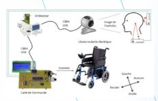
Le HTFD est un système d'aide au pilotage d'un fauteuil roulant, basé sur les mouvements de la tête de la personne à mobilité réduite.
